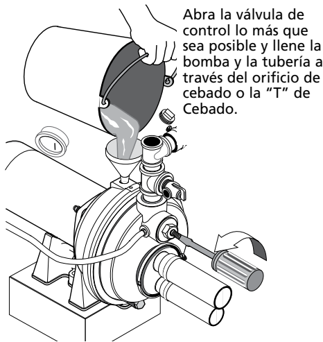
Figura 13 – Llenado de la Bomba
